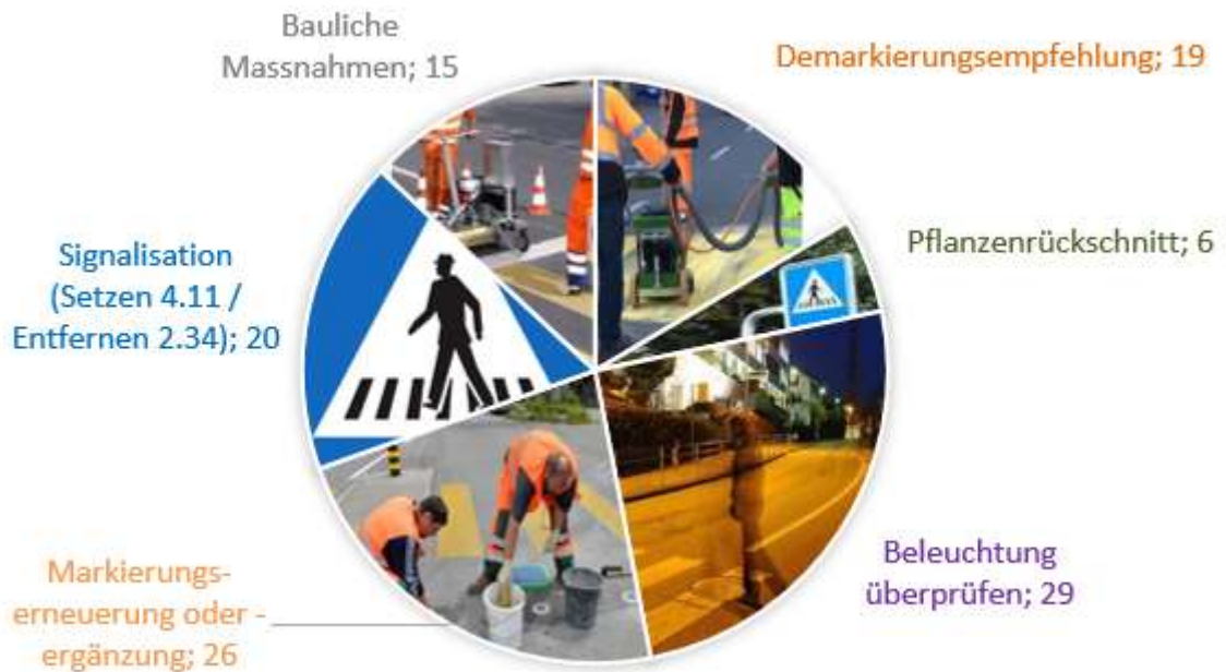
Abb. 97: Verteilung der Mängel an FGS in der Stadt SH (Mehrfachnennung möglich)
