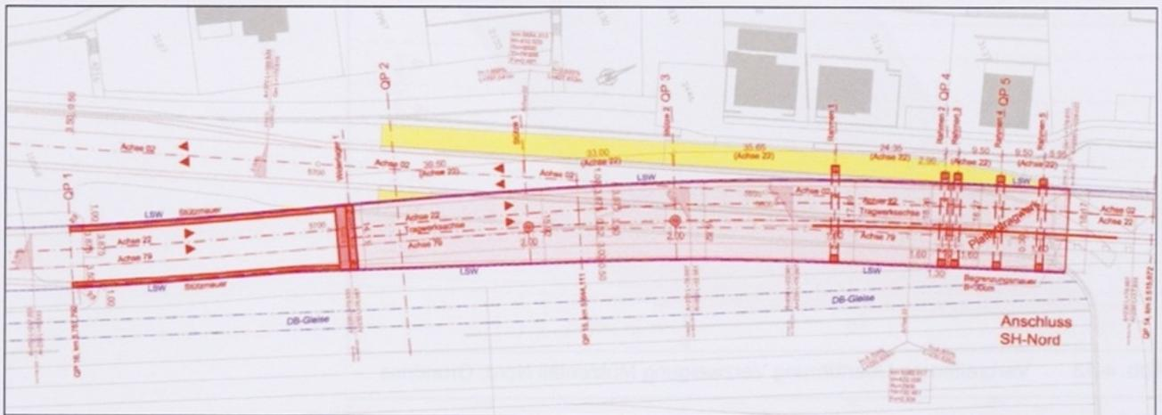
Abb. 4-11 Situation Rampe SH Nord mit Abbruch der bestehenden Ein- und Ausfahrtrampen
